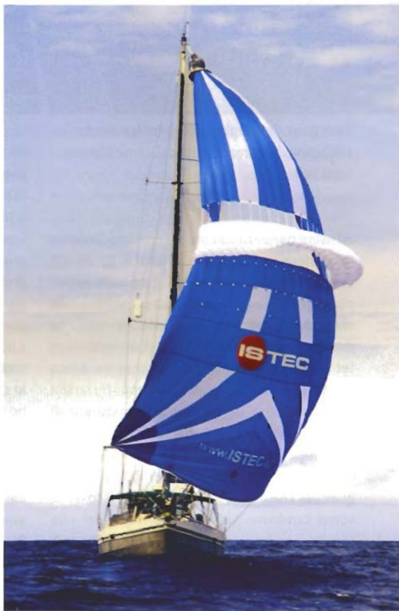
Lo spinnaker ParaSailor con le sue caratteristiche: la fessura e l'ala
